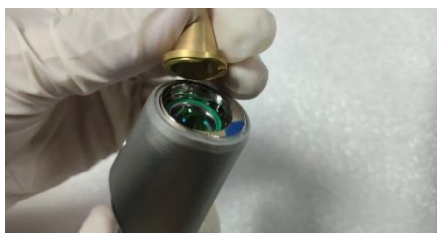
9. 把铜嘴下方气孔处对准枪身台阶片;
