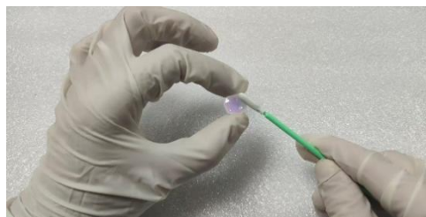
6. 用手镊住镜片周边, 用棉签清洗镜片;
