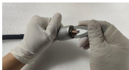
12. 用 Y 型夹具逆时针拧紧锁紧环;
